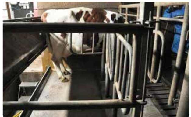
Figur 2.75. God arbejds højde og adgang til yver, ben og klove uden risiko for at blive sparket. Mulighed for at behandle køerne forfra ved hoved og hals.
