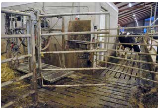
Figur 2.10. Denne låge bruges til at skubbe koen ind i klovbeskæringsboksen.
